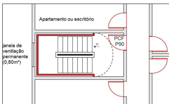
Figura 7 - Escada enclausurada protegida
